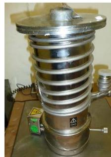
気化油拡散真空バキューム装置画像
